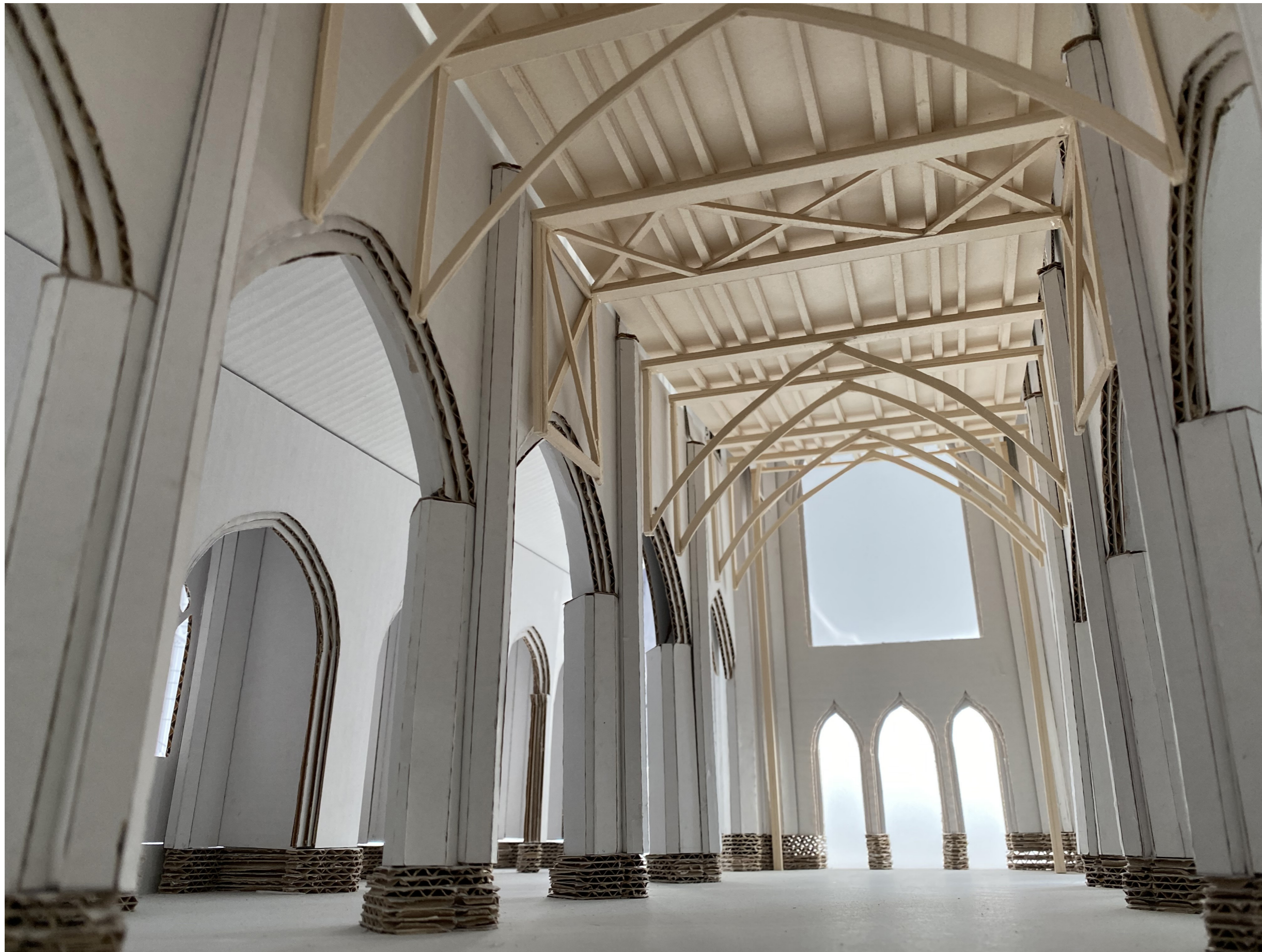
06: Kartonmodell mit Gerüstplattform, Zustand Berner Münster ab 2021-2024. Blick Richtung Orgel. Modell und Foto: Larissa Hasler, Häberli Architekten AG, Bern.
