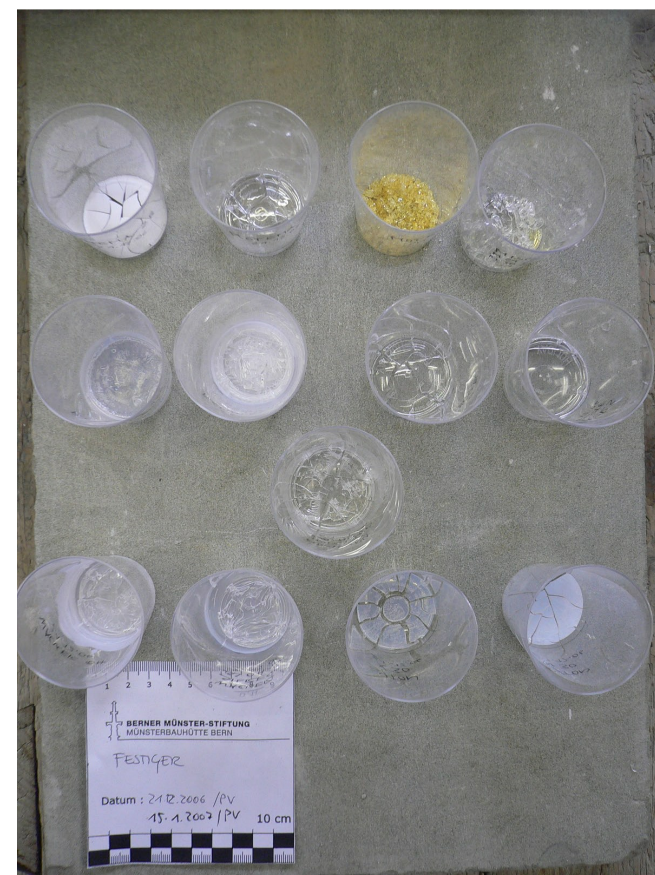
2007: Beobachtung und Dokumentation von Aushärtezeit, Verfärbungen, Elastizität etc. derselben Produkte. Hierfür wurden die Festiger zum Ausreagieren in offenen Bechern stehen gelassen.
