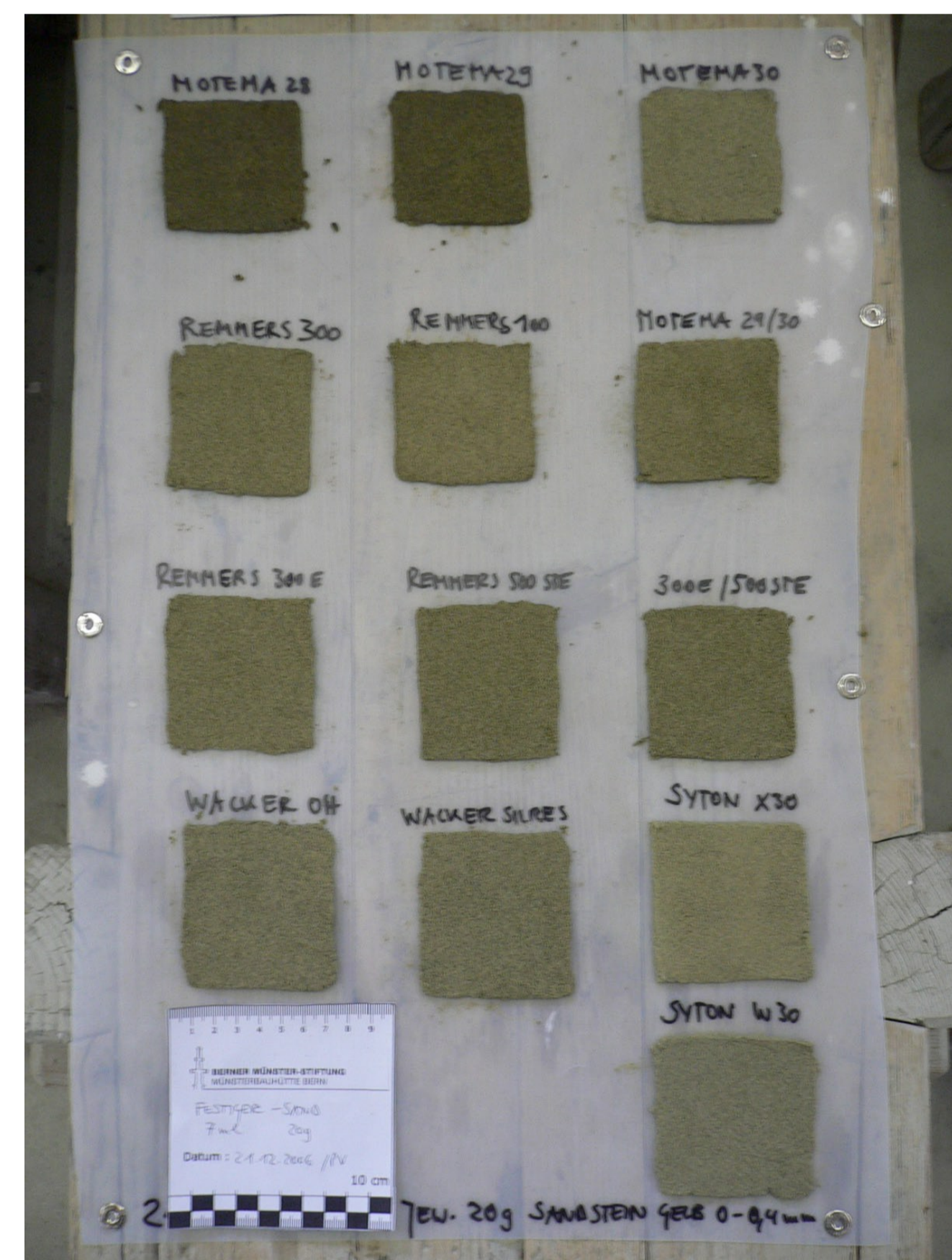
Materialversuche 2006: Sand mit unterschiedlichen Festigern angerührt und ausgetrichen. Beobachtung der Dauer des Abbindens sowie die Festigkeitsentwicklung von verschiedenen Produkten.
