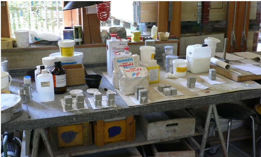
In der dritten Versuchsreihe wurden die Klebewirkung und die Wasserkapillarität respektive die Diffusionsoffenheit der Verpressmaterialien betrachtet. Hierfür wurden jeweils zwei Sandsteinwürfel mit den Verpressmaterialien zusammengeklebt, anschliessend ins Wasser gestellt und das Saugverhalten beobachtet.
