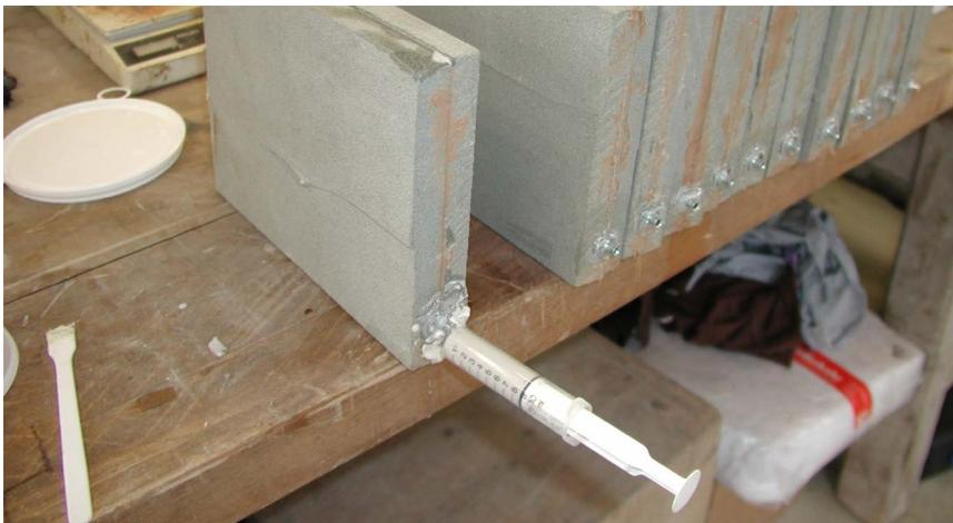
1. Versuchsreihe: Zwei ca. 15 x 20 cm grosse Sandsteinplatten wurden zusammengefügt, die Fugenstärke verjüngte sich von 1mm auf 0. Die Fugen wurden mit Latex abgedichtet und die Verpressmasse wurde über einen Metallpacker, der mittels Heisskleber aufgeklebt wurde, von unten nach oben mit einer Spritze eingepresst.
