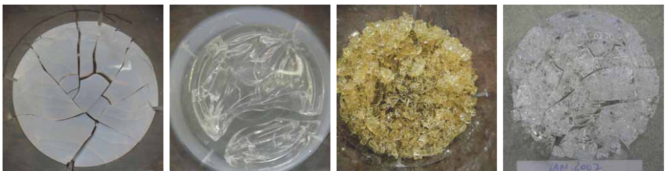
Deutliche Unterschiede bei der Alterung der verschiedenen Festigerprodukte im Becher: vier gleich alte Produkte mit sehr unterschiedlichem Abbindeverhalten
