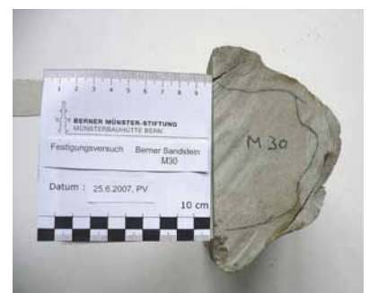
Zwei verschiedene Festigersorten auf verwittertem Sandstein: Die Unterschiede bei der Eindringtiefe und Festigkeitsentwicklung sind enorm.
