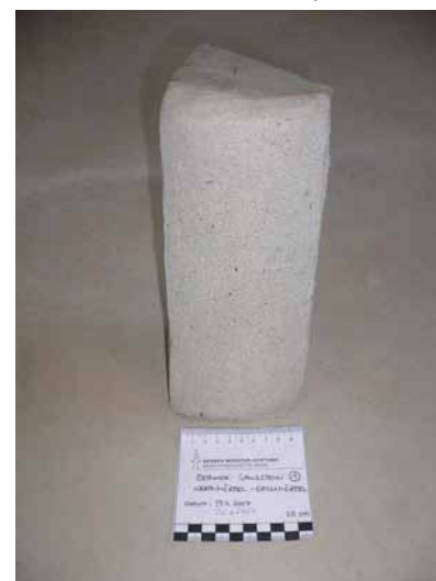
Stehend aufgemörtelter Kern- und Deckmörtel
