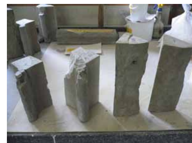
Verwitterte und gefestigte Steine als Grundlage für die Aufmörtelungen (links: Zuger Sandstein, rechts: Berner Sandstein)
