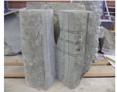
Aus den gefestigten Werkstücken werden Prüfkörper geschnitten
