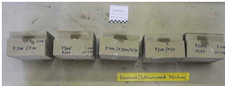
Überprüfung der Eindringtiefe am Berner Sandstein. Durch erneutes Benetzen der Oberfläche kann diese sichtbar gemacht werden.
