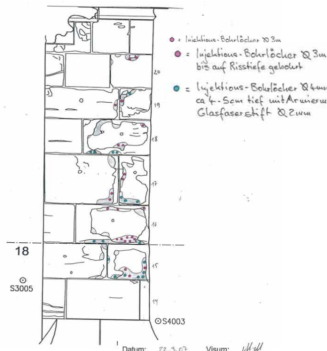
Die Versuche wurden durch die Münsterbauhütte genau dokumentiert. links: Zur Festigung verwendete Produkte und Mischverhältnisse, rechts: Anzahl und Tiefen der Injektionsbohrungen zur Sicherung der Schalen
