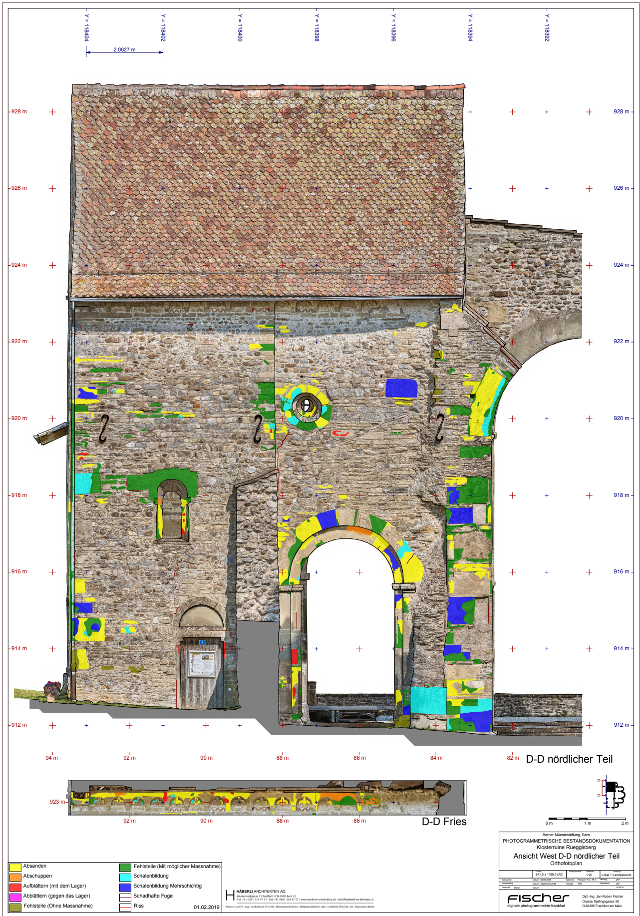
Auszug aus der Schadenskartierung der Klosterruine Rüeggisberg. Grundlage: digitale Photogrammetrie Jan-Ruben Fischer, Frankfurt (D).
